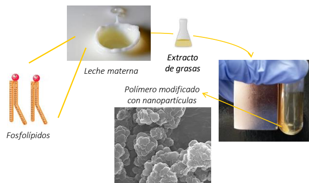
Figura 4. Fotografías del material polimérico modificado con NPs magnéticas usado en SPE magnética y su caracterización por SEM. (De ref. 21).
