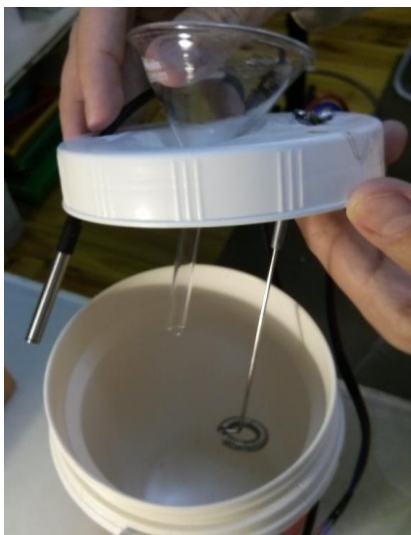
Figura 5. Detalle del recipiente térmico. También se observa el termómetro y el motor/agitador.
