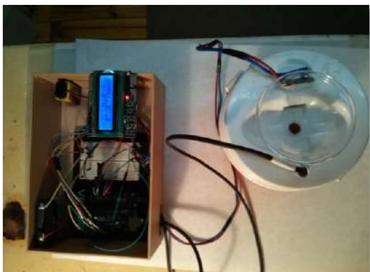
Figura 4. Calorímetro electrónico en su conjunto. A la izquierda se observa la parte electrónica con el microprocesador y a la derecha el recipiente para los ensayos.
