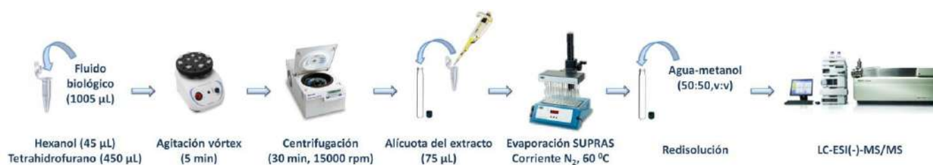
Figura 2. Protocolo general para la eliminación de efectos matriz en el análisis de fluidos biológicos mediante LC-ESI-MS/MS.
