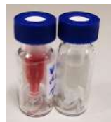
Figura 4. Extractos de vino tinto obtenidos durante el análisis de glifosato derivatizado con FMOC-Cl. Derivatización directa sobre el vino diluido (izquierda). Extracción previa usando un MIP seguida de derivatización con FMOC-Cl (derecha).
