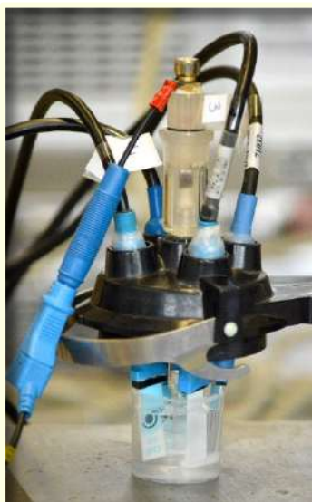
Figura 4: Lengua electrónica diseñada por el grupo de Electroanálisis, constituida por cuatro electrodos serigrafiados modificados.
