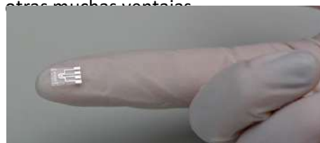
Figura 3. Celda electroquímica miniaturizada con electrodos de película fina metálica para volúmenes de 1-5 \mu\text{L} . Imagen tomada de [7].
