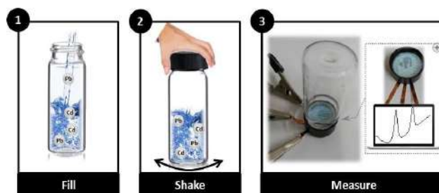
Figura 4. Esquema del procedimiento para la determinación de Pb y Cd en aguas con electrodos insertados en el tapón del recipiente de muestreo.
