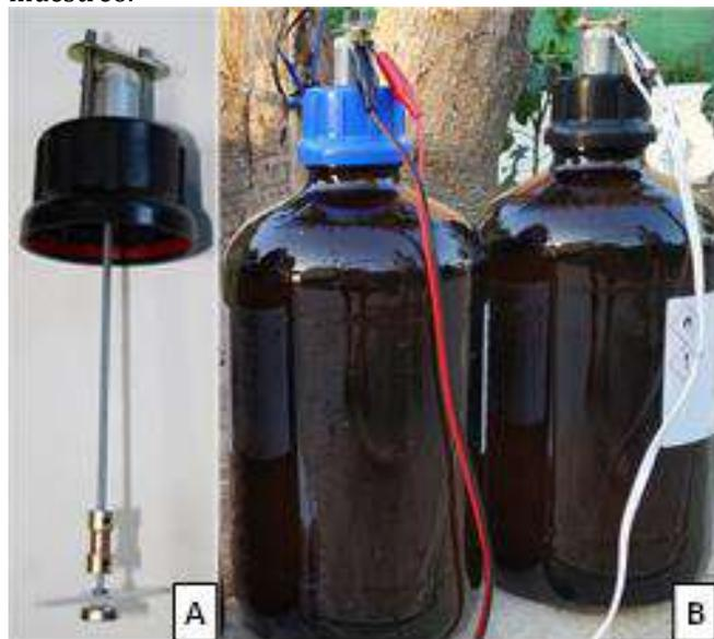
**Figura 3.** Dispositivo de extracción basado en mini-motores eléctricos. A) Unidad de extracción; B) Unidad de extracción acoplada a la botella de muestra. Imagen reproducida con permiso de Elsevier de la referencia [12].
