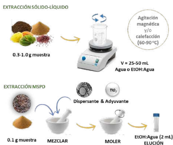
Figura 2. Esquema de los métodos de extracción sólido-líquido y por dispersión de matriz en fase sólida desarrollados para la recuperación de polifenoles a partir de diferentes biorresiduos agroalimentarios.
