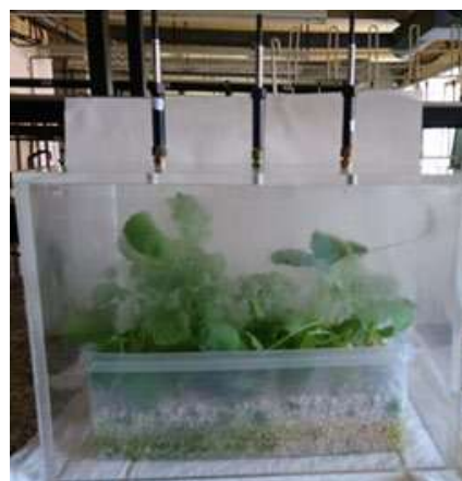
Figura 3. Sistema de extracción de las especies orgánicas de naturaleza volátil de selenio.
