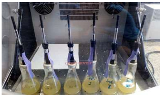
Figura 7. Sistema de extracción de las especies orgánicas de naturaleza volátil de selenio y de selenio-azufre.
