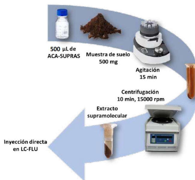
Figura 2. Procedimiento para la extracción de los CPAH de muestras de suelo
