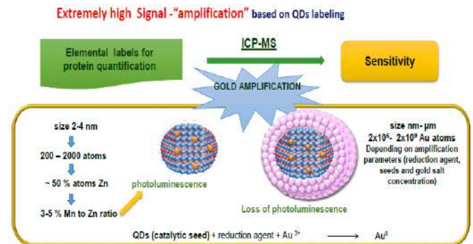
Figura 6.- Amplificación química de la señal en ICP-MS, tras la reducción/deposición catalítica del Au sobre los QDs utilizados.
