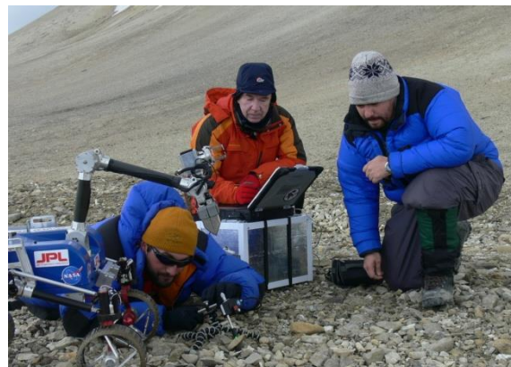
Figura 4. El instrumento Raman trabajando en el Ártico en coordinación con un nuevo prototipo de "rover" de NASA para recogida de muestras automática en futuras misiones de retorno a Marte.
