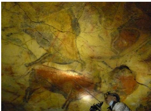
Figura 5. Análisis in-situ por espectroscopia Raman de los pigmentos de las figuras de la cueva de Altamira.
