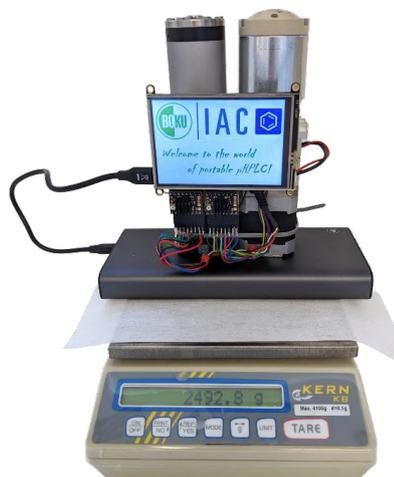
**Figura 5.** Fotografía del prototipo de HPLC portátil formado por la bomba de pistones axiales M6HP y la válvula C5-2359D-CU; controlador con pantalla táctil y power bank. El peso total está por debajo de 2.5 kg.
