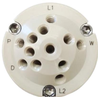
**Figura 4.** Estator de la válvula C5-2359D-CU. Nótese el diseño no convencional altamente asimétrico, así como los puertos dedicados para la bomba (P), detector (D), bucle de inyección (L1, L2) y Waste (W).
