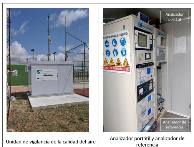
Fig 1. Montaje experimental para medida de concentraciones de ozono en el aire ambiente.
