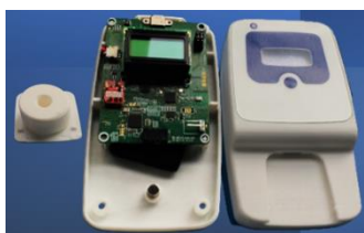
Fig 6. Prototipo portátil de biosensor electroquímico operado por baterías, que incluye el cartucho, el lector y la electrónica involucrada.
