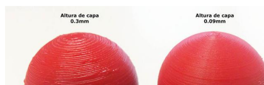
Fig. 3. Ejemplo de impresión a dos alturas de capa y como afecta a la impresión. Fotografías obtenidas de http://wiki.ikaslab.org (CC BY).
