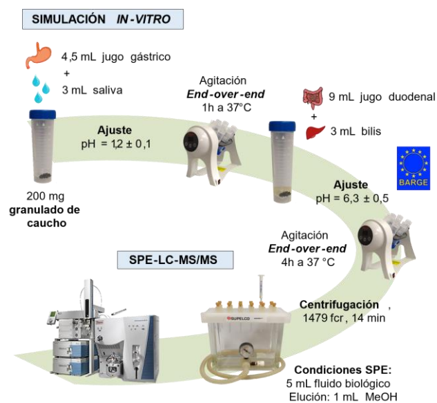
Fig. 2. Procedimiento de análisis para la realización de los estudios de bioaccesibilidad [9].
